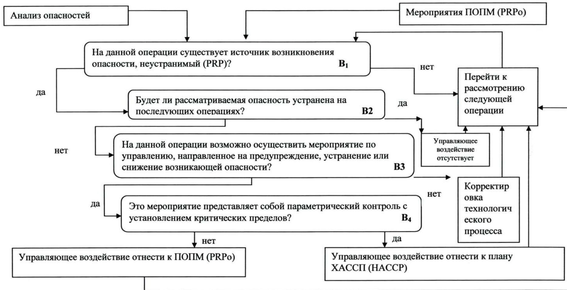
Рисунок 8.1 – алгоритма выбора и классификации мероприятий по управлению путем последовательного анализа операций технологического процесса рисунок 1
